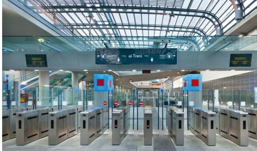
Die Verglasung des Bahnhofs Torino Porta Susa ist mit monokristallinen Photovoltaikzellen ausgestattet. Neben der Stromproduktion dienen sie auch als Sonnenblende. Quelle: © Dario Egidi, iStockPhoto
