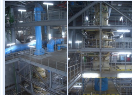
REAplus-Pilotanlage seit 2009 ⇒ SO 2 -/Staub-Minderung
